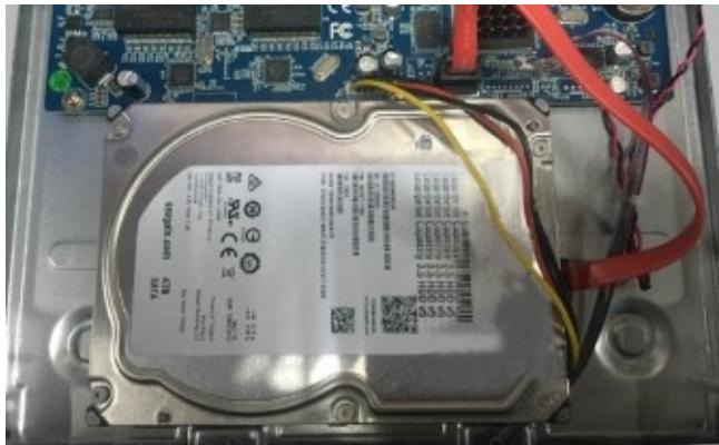
Po przykręceniu dysków należy podłączyć do dysków kable zasilające i sygnałowe.
