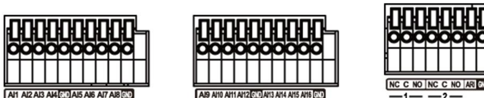
Widok wejść i wyjść alarmowych dla rejestratora NDR-HB4416
