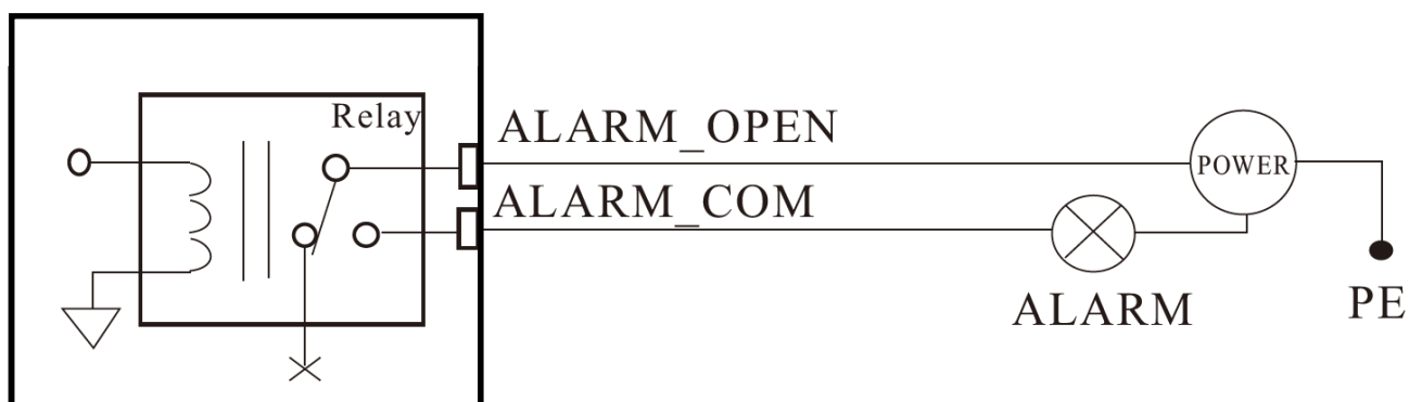
Typowe połączenia wyjścia alarmowego Maks. 30VDC/1A
