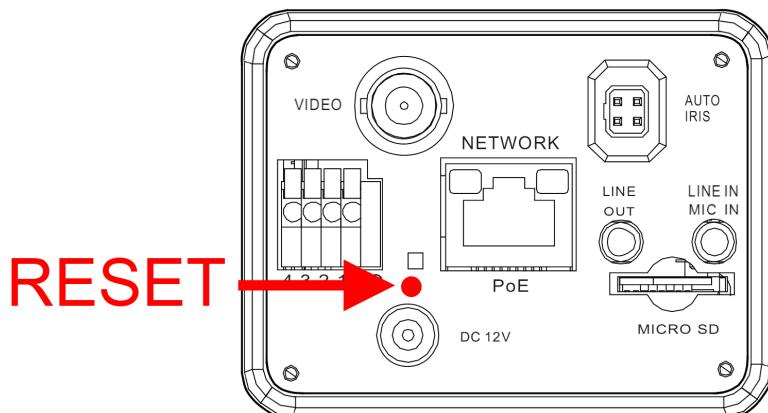
Przycisk reset znajduje się wewnątrz otworu zazначенego na rysunku. Do jego wcisnięcia należy użyć cienkiego przedmiotu np. zapałki
