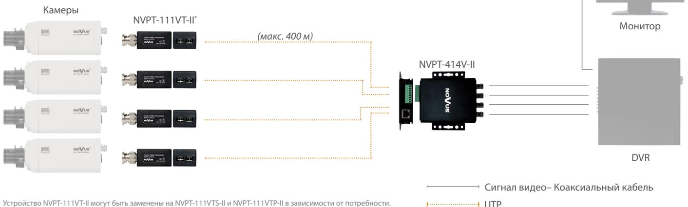
Устройство NVPT-111VT-II могут быть заменены на NVPT-111VTS-II и NVPT-111VTP-II в зависимости от потребности.
