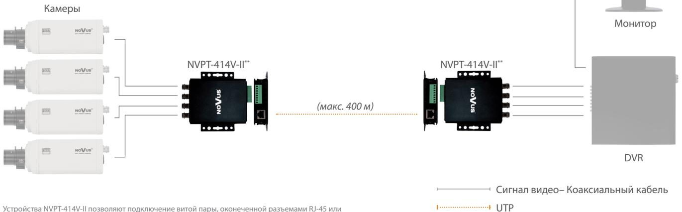
Устройства NVPT-414V-II позволяют подключение витой пары, оконеченной разъемами RJ-45 или непосредственно подключенной к винтовым клемм устройства.
