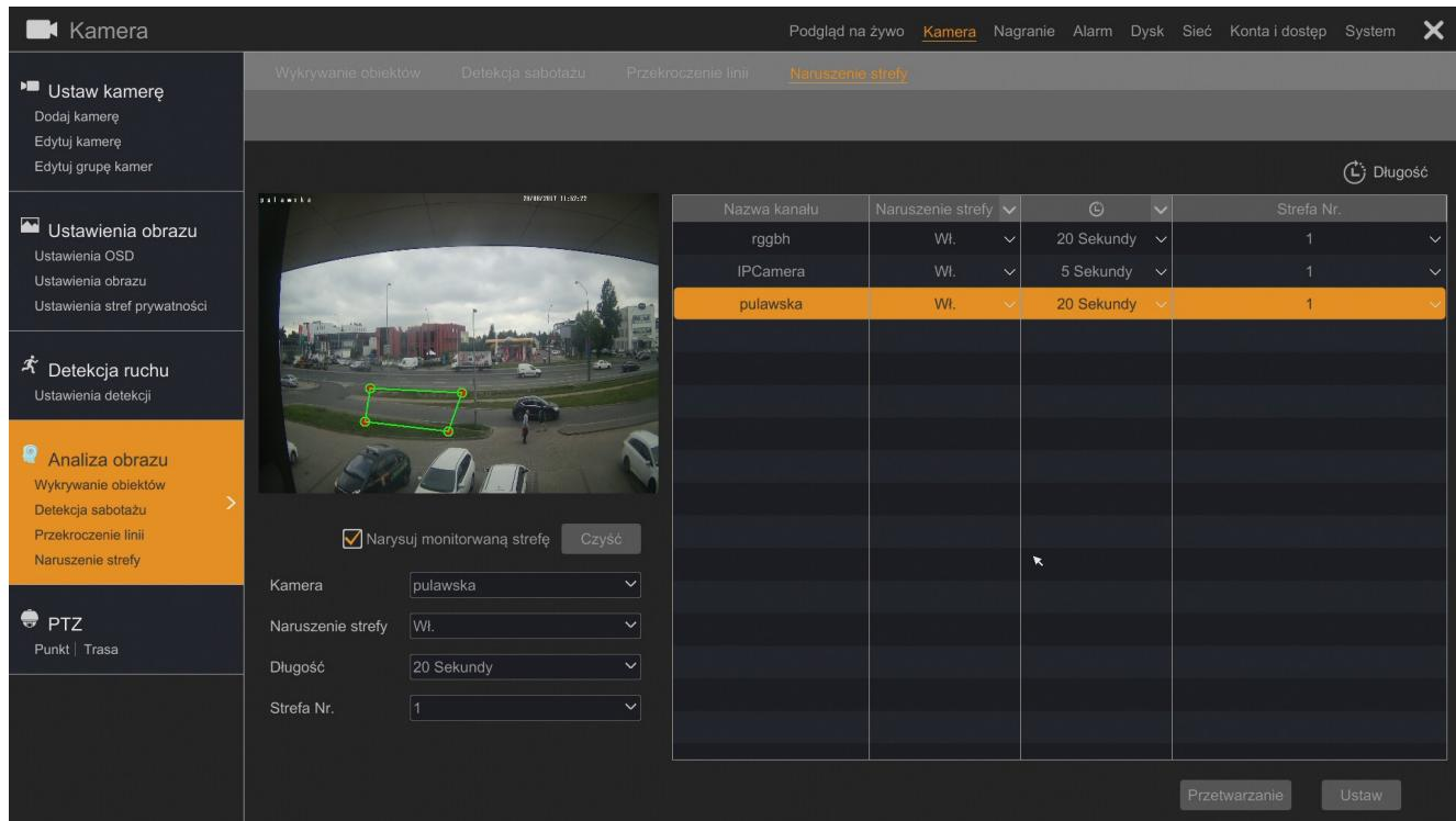
Aby narysować strefę zaznacz opcję NARYSUJ MONITROWANĄ STREFĘ i zaznacz na obrazie strefę składającą się z maksymalnie 6 punktów ograniczających używając lewego przycisku myszki. Następnie naciśnij przycisk USTAW aby uruchomić monitorowanie strefy. Uruchomienie analizy naruszenia strefy wyłącza analizę wykrywania obiektów i przekroczenia linii. Przejście obiektu przez strefę wyzwoli alarm.
