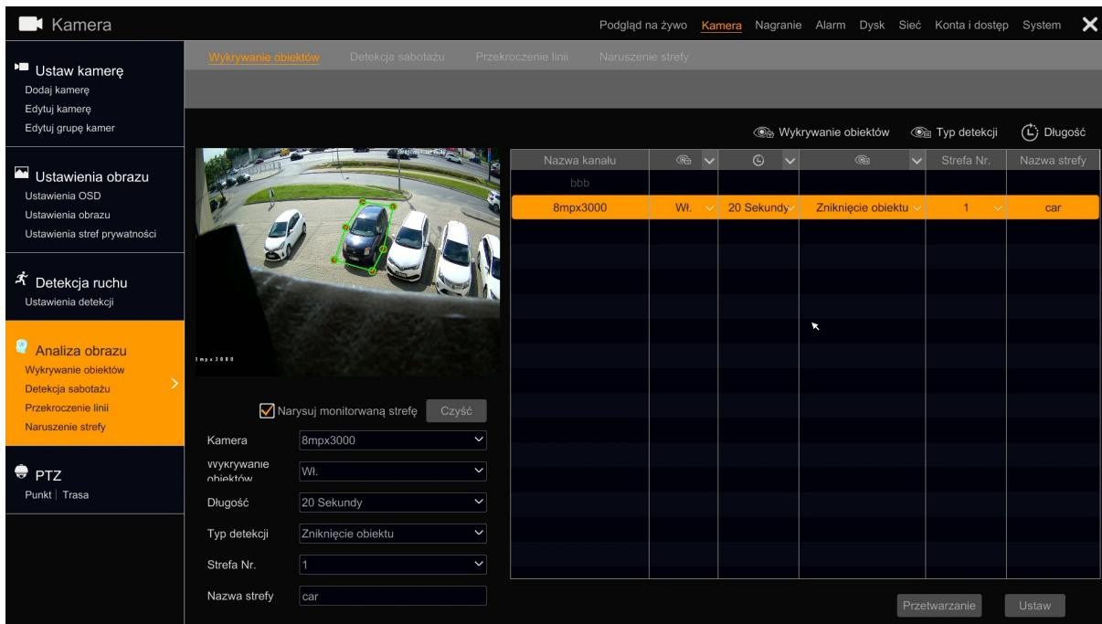
W tabeli wyświetlanej po prawej stronie wyświetlana jest lista kamer obsługujących wybraną analizę obrazu. Kliknięcie na wybranej kamerze wyświetli jej ustawienia analizy obrazu. Na liście dostępne są następujące ustawienia :
