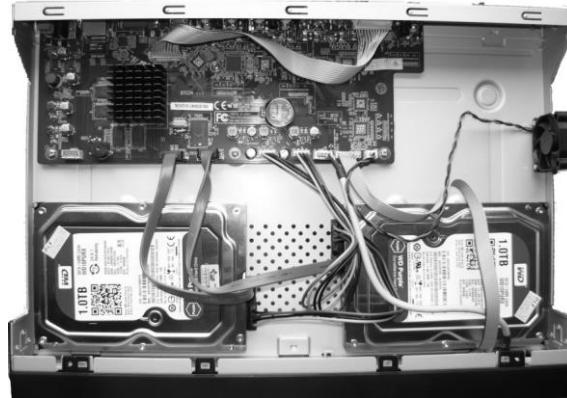
Nach Entfernen der Abdeckung die Disk(s) mithilfe von Feststellschrauben (4 Stück auf Disk) montieren; dann Strom- und Signalkabel anschließen.
