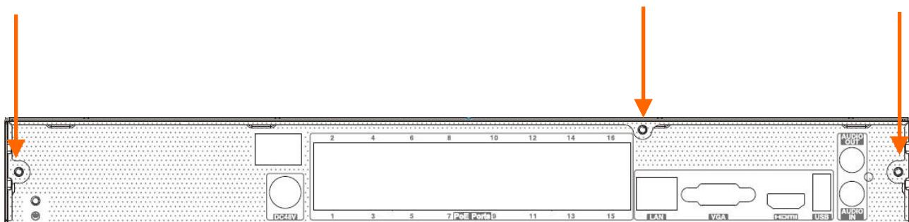
Nach Entfernen der Abdeckung die Disk(s) mithilfe von Feststellschrauben (4 Stück auf Disk) montieren; dann Strom- und Signalkabel anschließen.
