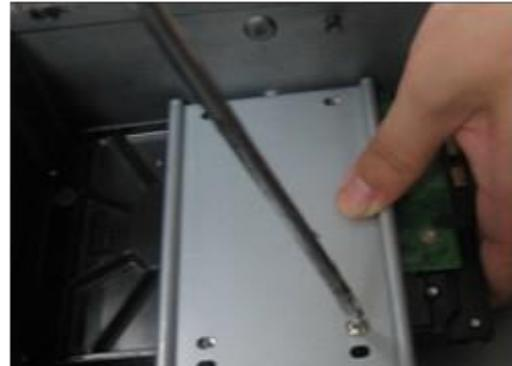
Montieren Sie als nächstes die Racks in der DVR und schließen Sie die Strom-/Signalkabel an.
