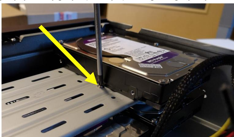
Po podłączeniu dysków twardych należy zamknąć obudowę rejestratora dokręcić śruby mocujące szyny z boku rejestratora.
