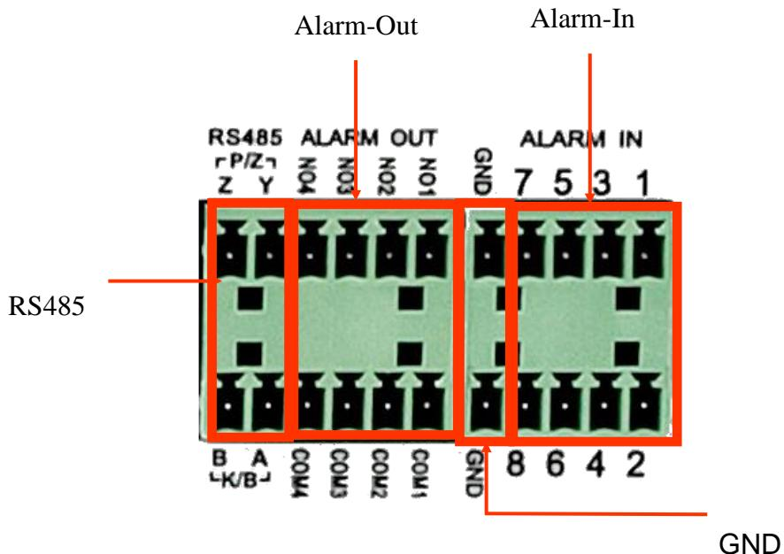
Beispiel für Anschließen von Alarm-Output Nr. gemäß Zeichnung unten:
