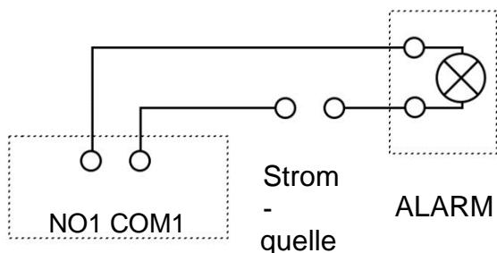
Beispiel für Anschluss eines Sensors an Alarm-Input 1.
