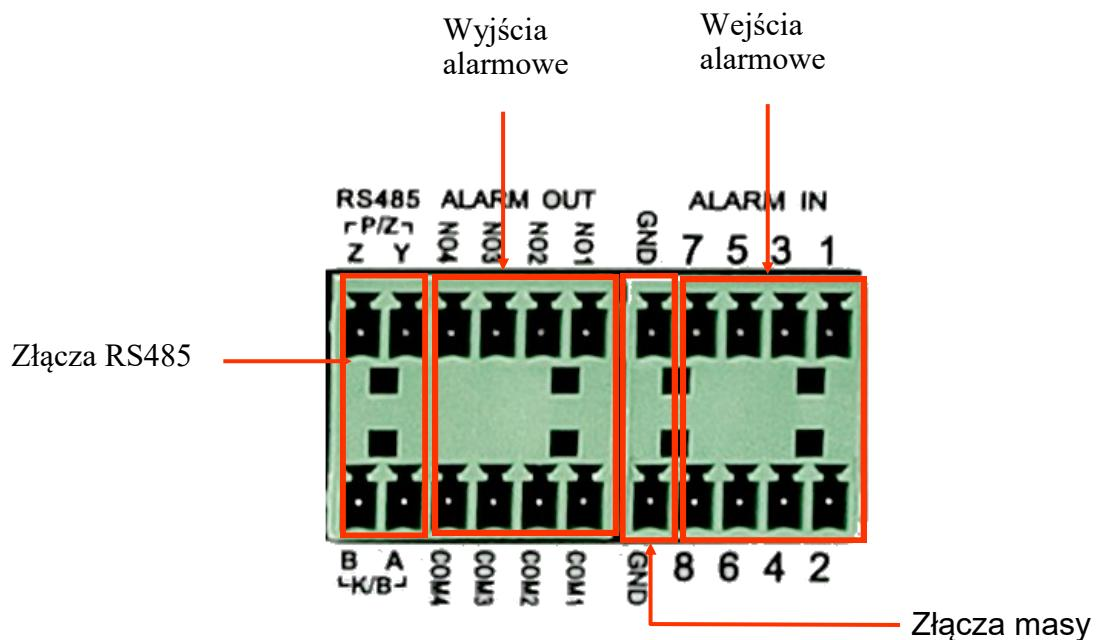
Przykład podłączenia wyjścia alarmowego nr. 1 należy wykonać zgodnie z rysunkiem przedstawionym poniżej:
