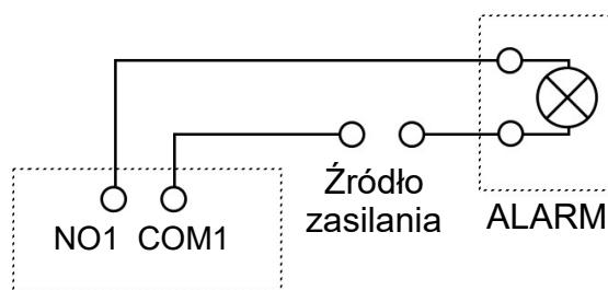
Przykład podłączenia czujnika do wejścia alarmowego nr 1.
