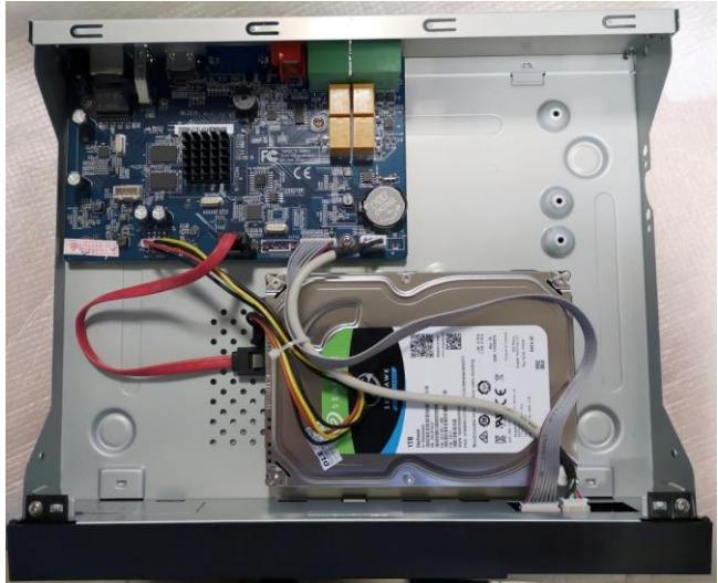
Nach Anschließen der Festplatte die Abdeckung montieren, NVR starten, um Festplatte zu prüfen und zu formatieren.
