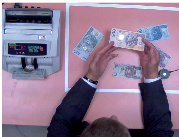
Fot. 2. Определение серийных номеров банкнот, область определения: 850x640 мм, камера 5 Мпикс.
