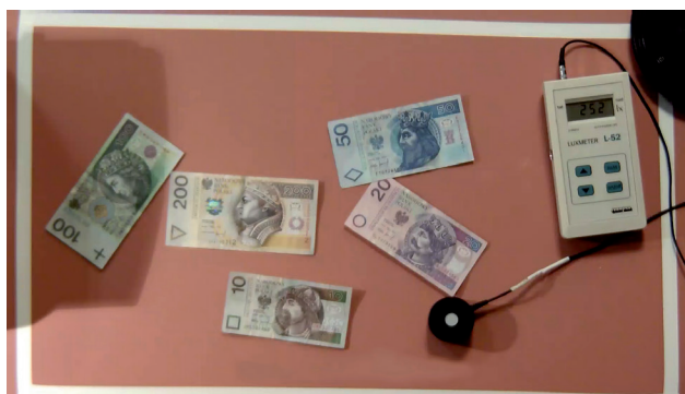
Fot. 3. Ухудшение качества изображения и способность определения номеров в случае интенсивности освещения в размере 200 люксов
